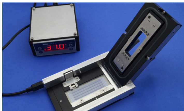
LOC CCI 1 温度調整機能付きチップホルダー (microfluidic ChipShop 製) エアタイトな流体接続と温度調整ができ灌流細胞培養を顕微鏡で観察可能
